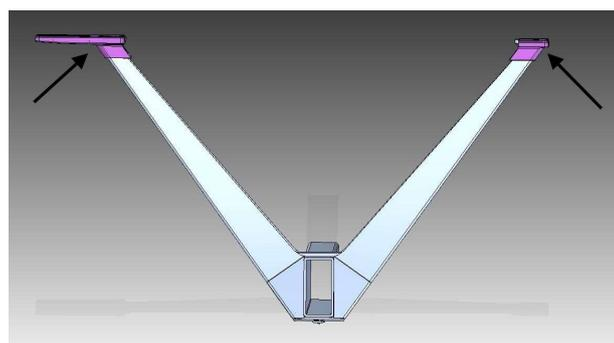
6. Załóż plastikową zaślepkę dociskając aż do usłyszenia dźwięku !klik! rys.6
