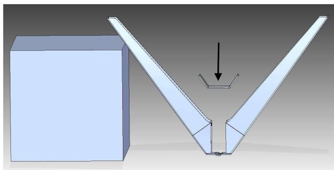
3. Wstaw nośną prostokątną belkę z zestawu po czym przykręć blaszkę dwoma śrubami M8 załączonymi do zestawu (Rys.3)
